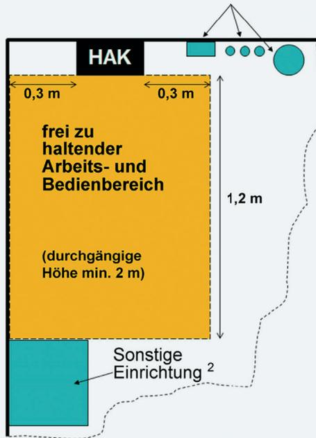
Einbau- und Betriebseinrichtungen<sup>1</sup>
