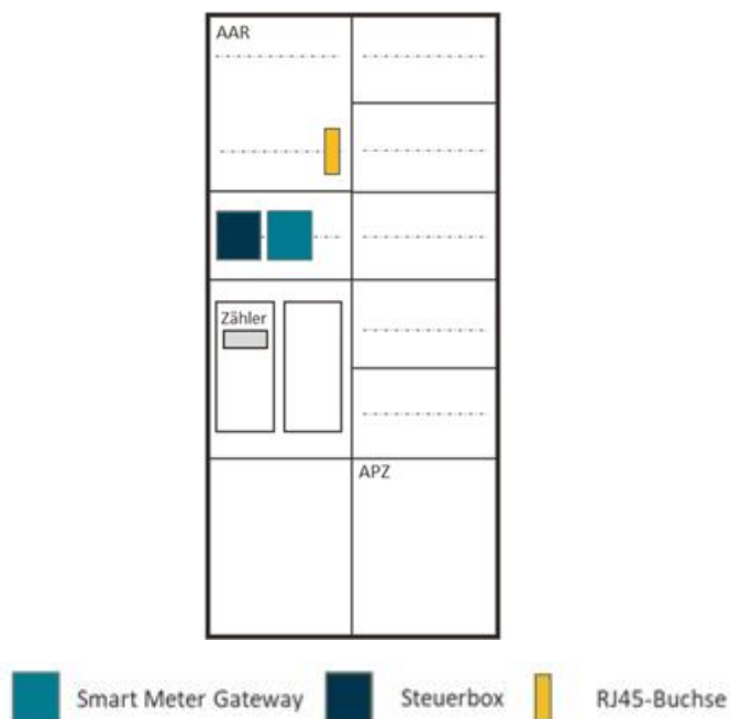
Abbildung 1: Digitale Steuerung über Steckzählerplatz
