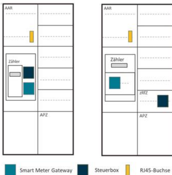
Abbildung 2: Digitale Steuerung über eHZ-tragfähigen Zählerplatz links: Einbau eines BKE-AZ zur berührungslosen Kommunikation mit dem eHZ rechts: Einbau der Steuerbox in separatem zRfZ
