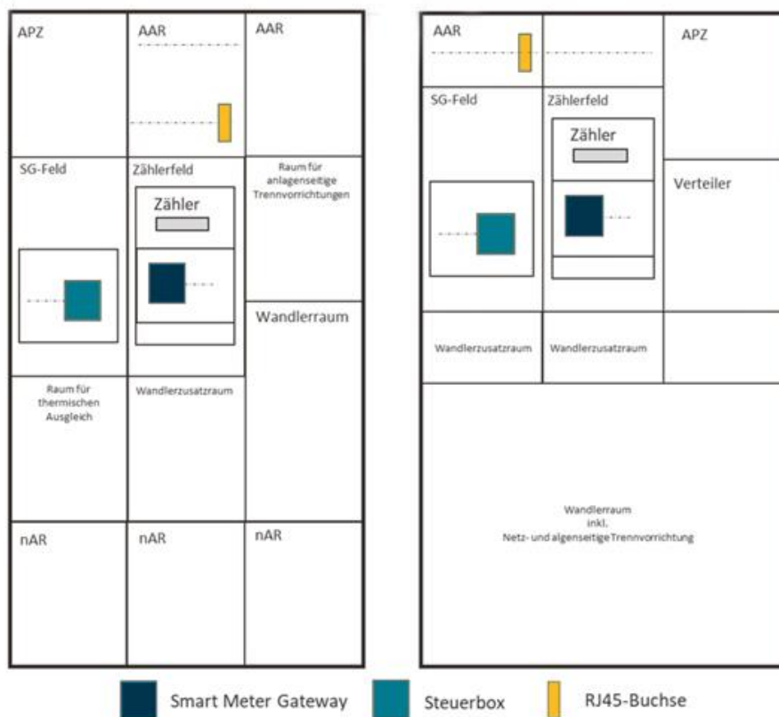
Abbildung 3: Digitale Steuerung bei halbindirekten Messungen links bis 250 A, rechts ab 250 A bis 1.000 A
