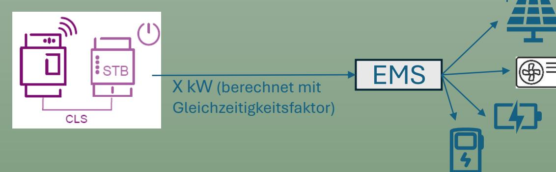
➤ Beide Varianten können über Relais oder mittels EEBUS-Protokolls realisiert werden
